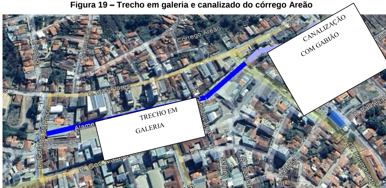
Figura 19 – Trecho em galeria e canalizado do córrego Areão
