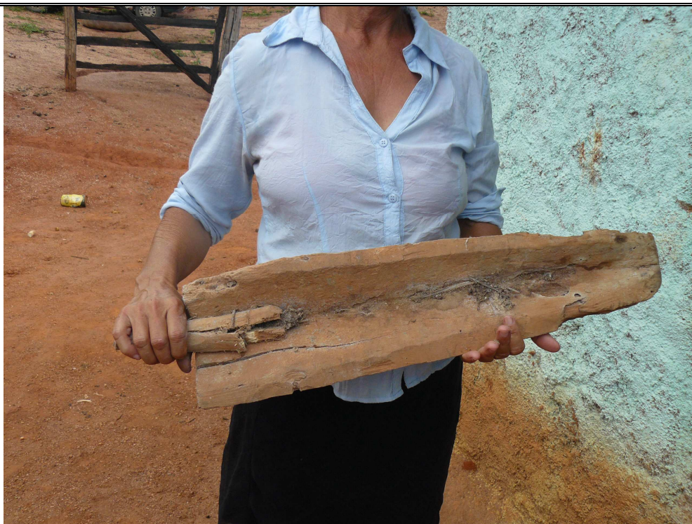
Foto 02 – Molde para telha
