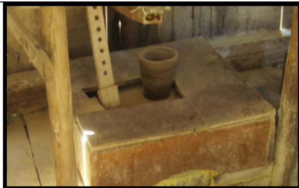
Detalhe do funil por onde passam os grãos de milho e vão para a moagem em duas pedras
