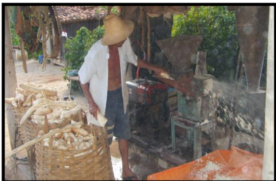
Ralagem da mandioca em um desintegrador.
