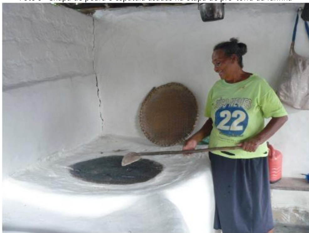
Foto 10- Chapa de pedra e espátula usadas na etapa de torra da farinha
