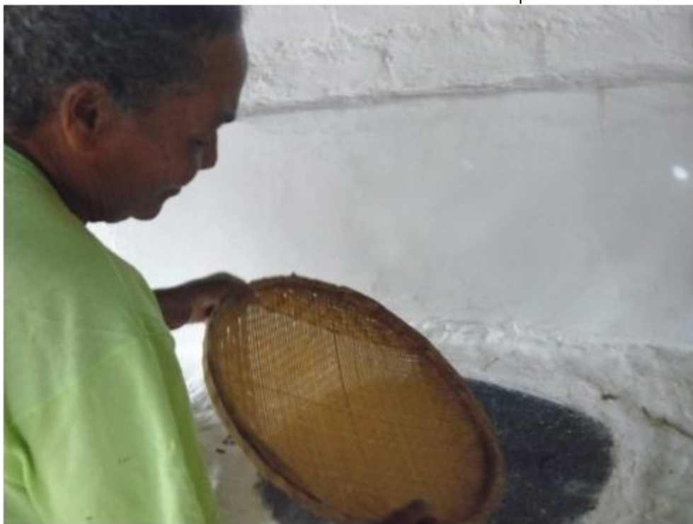
Foto 12- Peneira de bambu onde a farinha é coada
